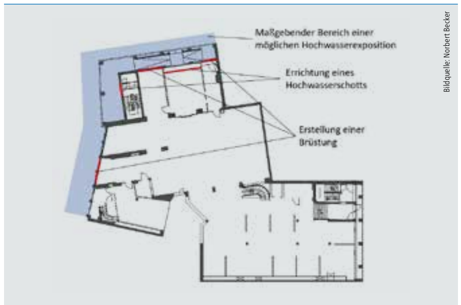
Grafik 4: Darstellung des Erdgeschosses unter Kennzeichnung der durchgeführten Hochwasserschutzmaßnahmen.
